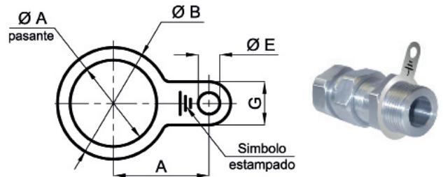
Espesor de chapa latón 0,8 mm.
